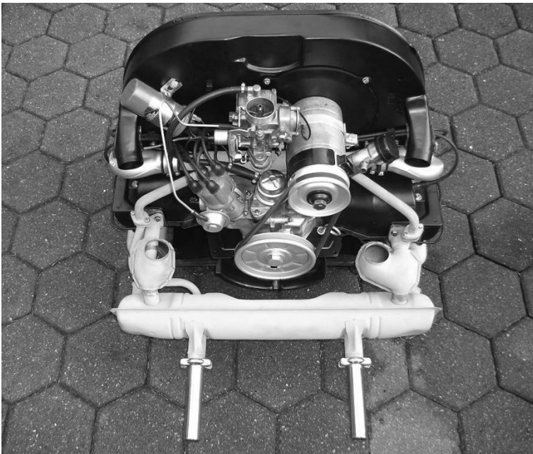
VW Käfer Typ1-Motor mit Serienluftkühlsystem
