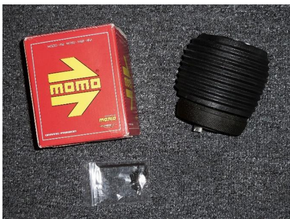
Momo Lenkrad-Naben-Kit, mit Feinverzahnung
