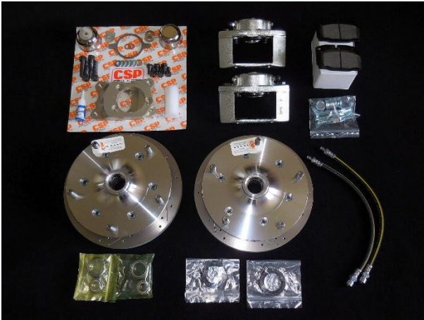
Scheibenbremsanlage vorn mit LK 5x205
